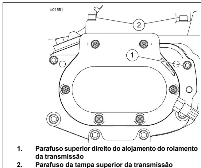
Figura 1. Locais de instalação do suporte de montagem
