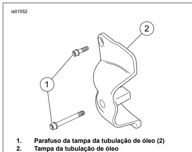
Figura 2. Remoção da tampa da tubulação
