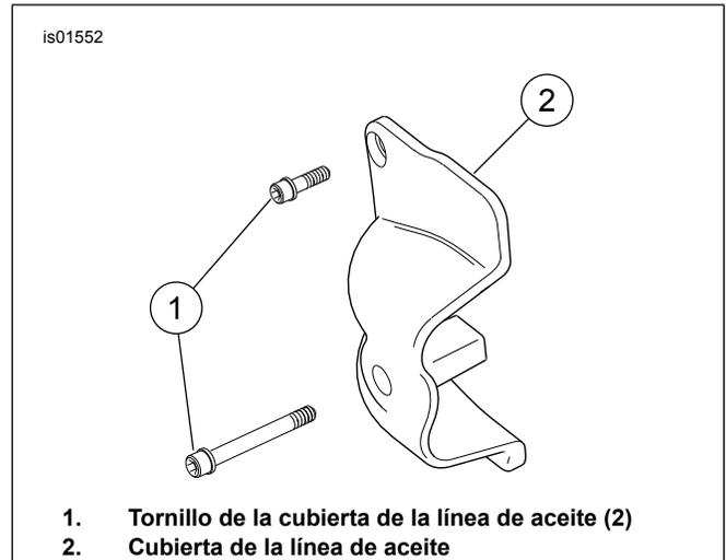
Figura 2. Extracción de la cubierta del aceite
