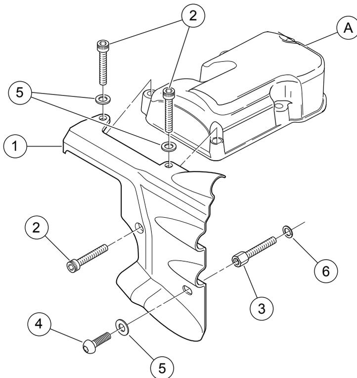
Figura 3. Piezas de servicio: cubierta de la interfaz motor/transmisión
