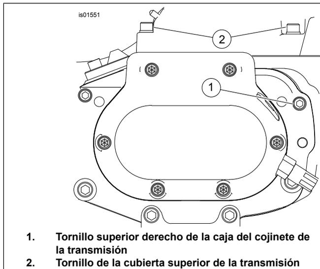
Figura 1. Ubicación de las piezas de soporte de montaje
