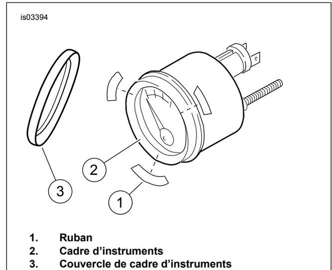
Figure 1. Installation de cadre d'instruments chromé
