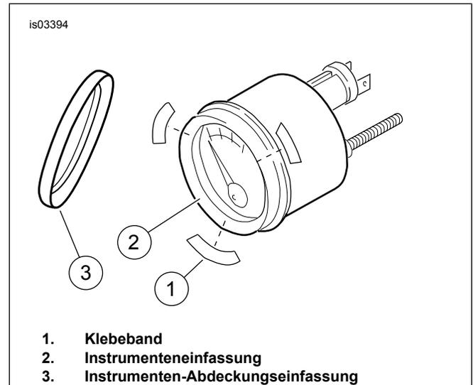
Abbildung 1. Verchromte Instrumenteneinfassung, Einbau
