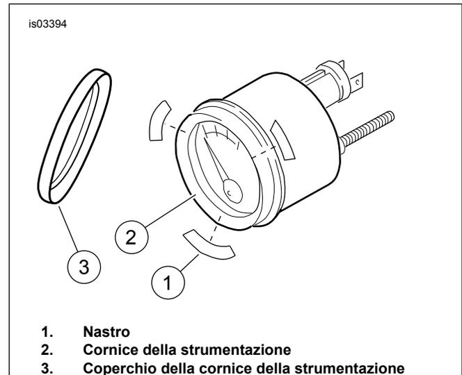
Figura 1. Installazione della cornice cromata della strumentazione
