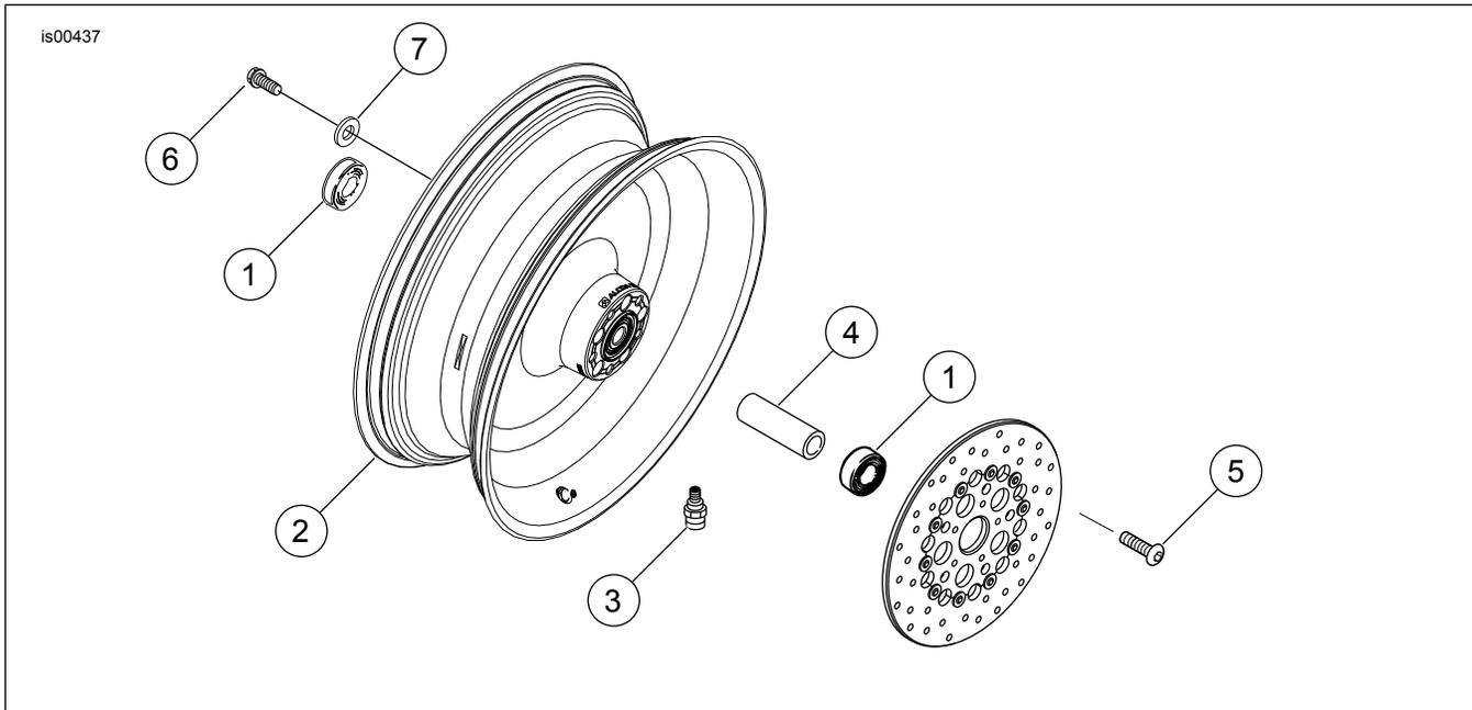
Abbildung 1. Ersatzteile: 17-Zoll-Chrom-Hinterradsätze (Rad mit geschlossenem Teller abgebildet)
