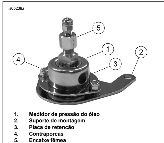
Figura 1. Conjunto do medidor de pressão do óleo e do suporte
