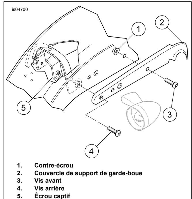
Figure 1. Support de garde-boue arrière (côté droit montré)
