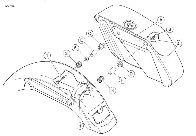
Figura 2. Peças de reposição: Ferragens do suporte, Sportster com alforjes
