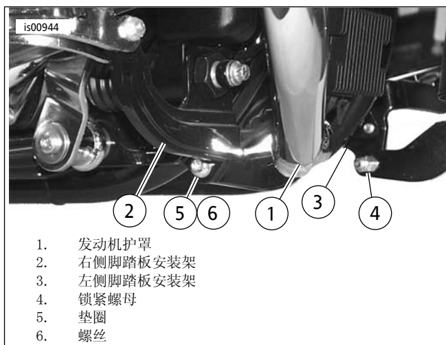
图3。发动机护罩下部底架( 右侧视图 )
