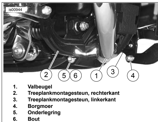
Afbeelding 3. Onderste bevestiging van de valbeugel (rechteraanzicht)
