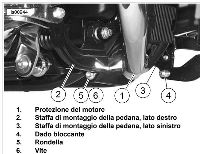
**Figura 3. Montaggio inferiore della protezione del motore (vista del lato destro)**
