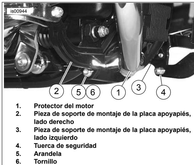
**Figura 3. Montaje inferior del protector del motor (visto del lado derecho)**
