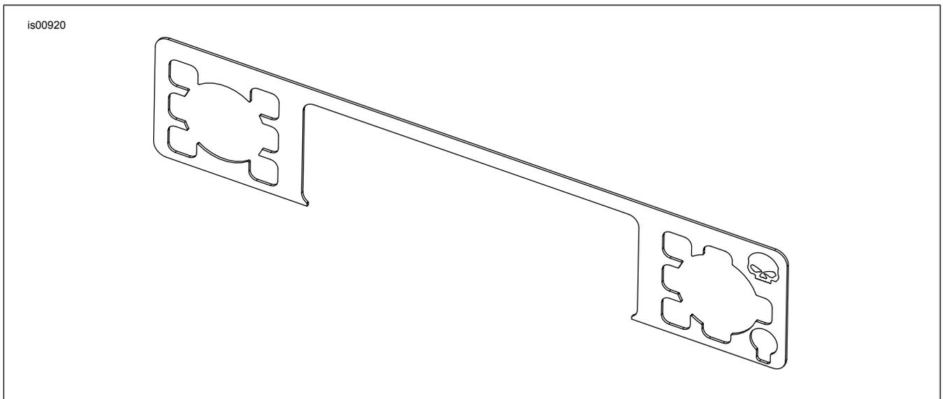
Figura 1. Guarnição do visor do rádio
