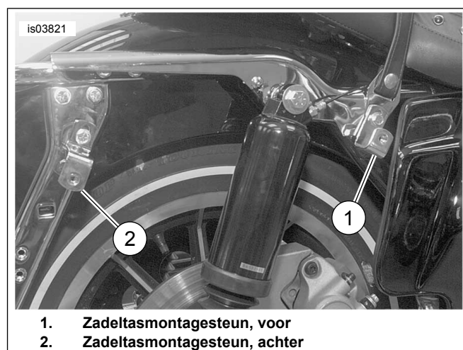
Afbeelding 8. Zadeltas van de montagesteunen verwijderen
