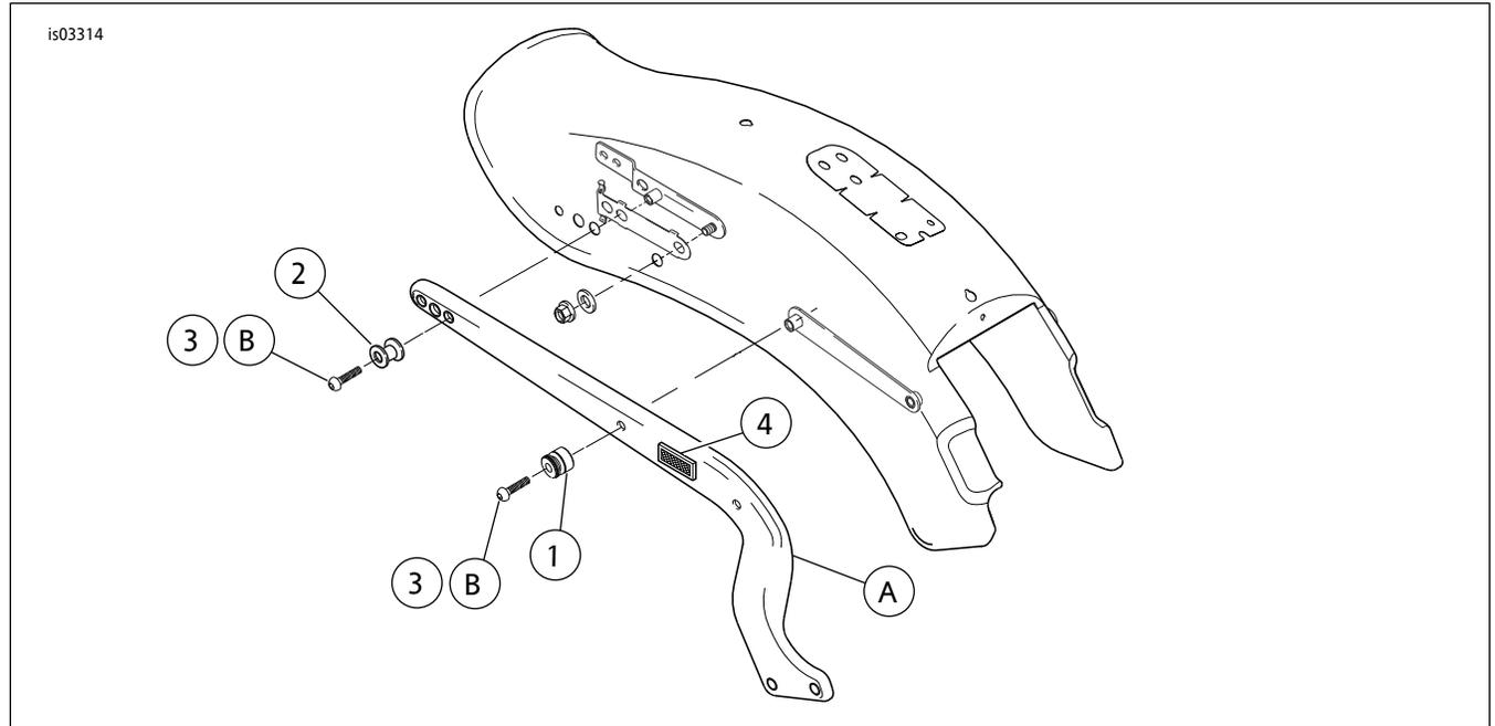
图4。维修零件：软尾无边箱支架对接五金件( 图示为FXST )
