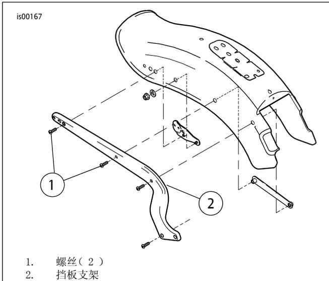
图2。拆卸螺丝 ( FXST/S/B )
