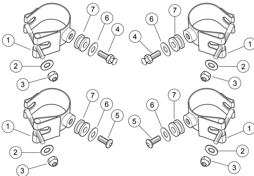
Figura 3. Parti di ricambio: Kit bulloneria di ancoraggio del parabrezza
