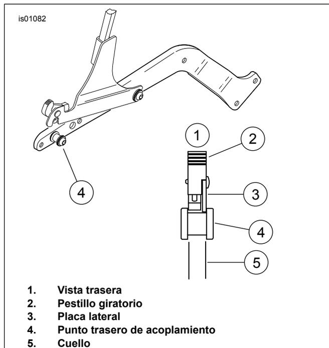
**Figura 4. Tire hacia atrás de los pestillos giratorios y baje la placa lateral sobre los puntos traseros de acoplamiento**
