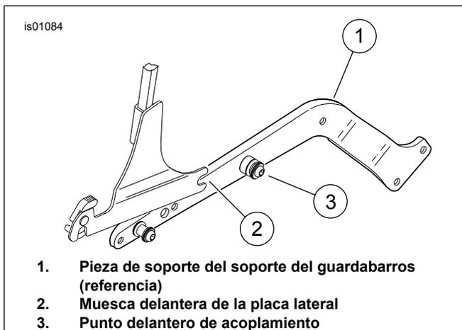
**Figura 3. Coloque las muescas delanteras en los puntos delanteros de acoplamiento**
