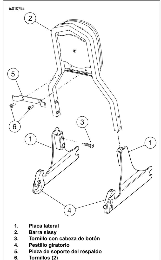
**Figura 1. Conjunto de placas laterales desmontables de la barra sissy**
