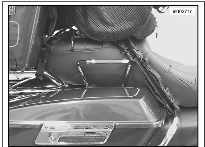
1. Befestigungsriemen an Rückenlehnen-Befestigungsschnalle angebracht
