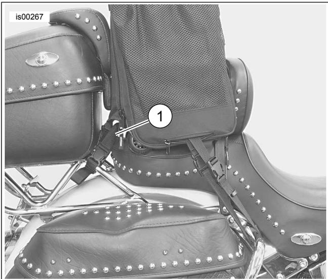
1. Befestigungsriemen an Rückenlehnen-Befestigungsschnalle angebracht
