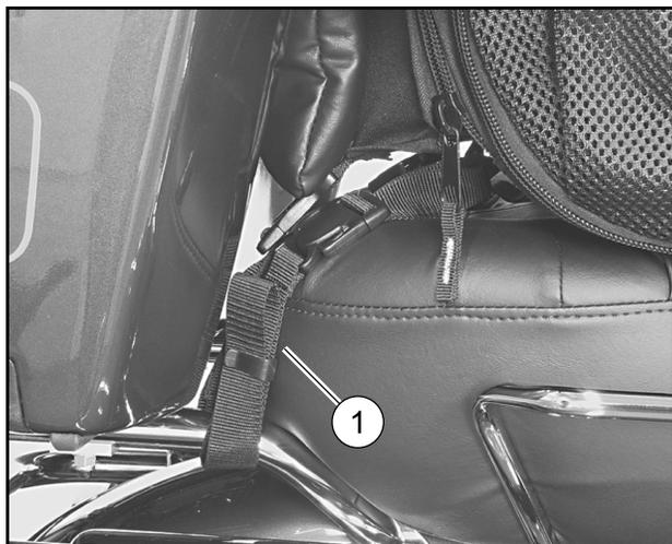
1. Tira de montagem fixada na fivela da montagem do encosto
