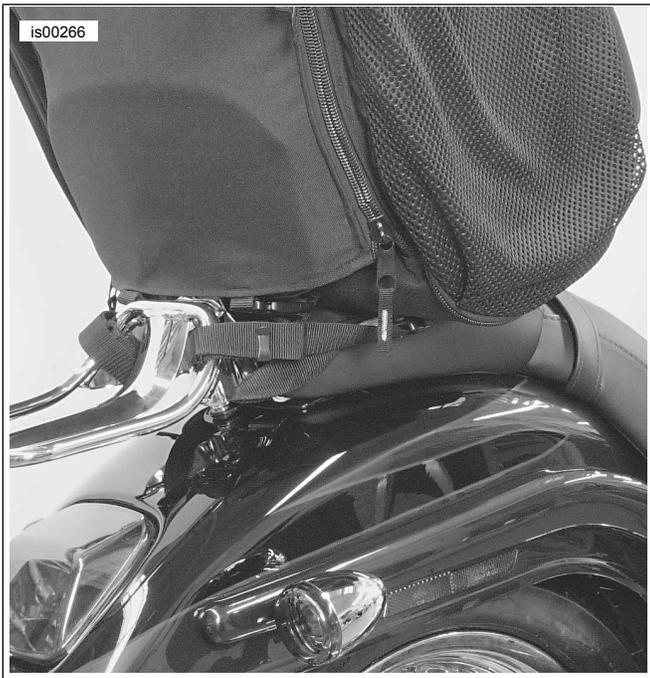
**Figura 7. Configuración 2 de la correa**
