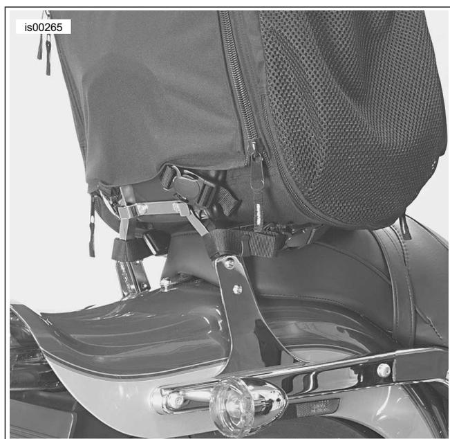
**Figura 6. Configuración 1 de la correa**
