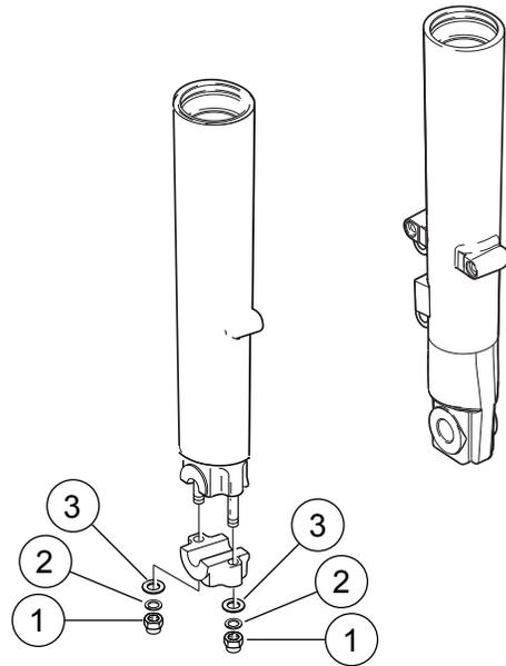
Figura 2. Peças de reposição: Kit da porca da capa do eixo dianteiro
