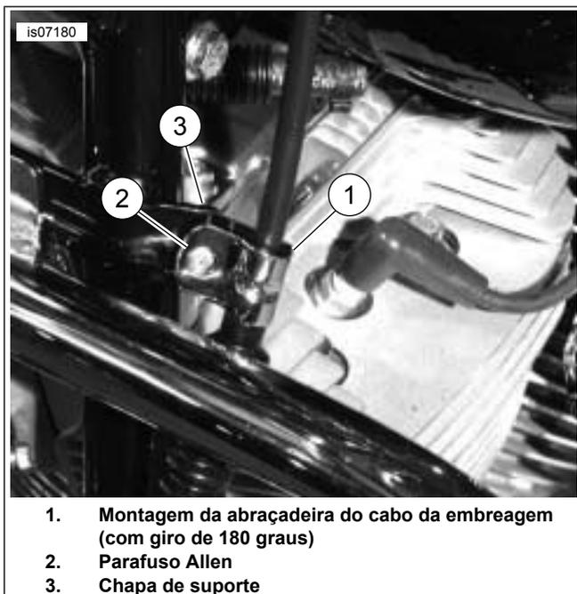
**Figura 2. Instalação do clipe de cabo da embreagem –
