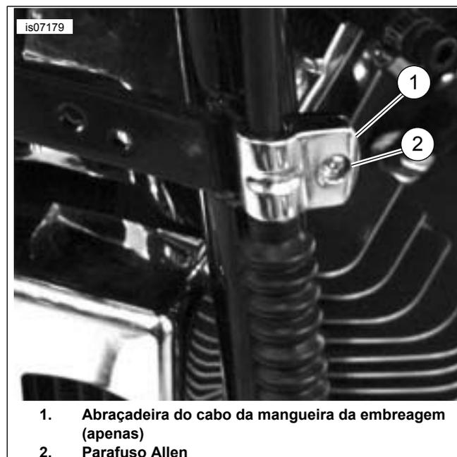
Figura 1. Instalação da abraçadeira de cabo da embreagem
