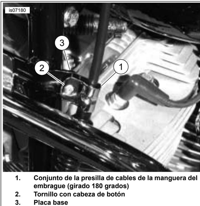
**Figura 2. Instalación del conjunto de la presilla del cable del embrague con el protector del motor**
