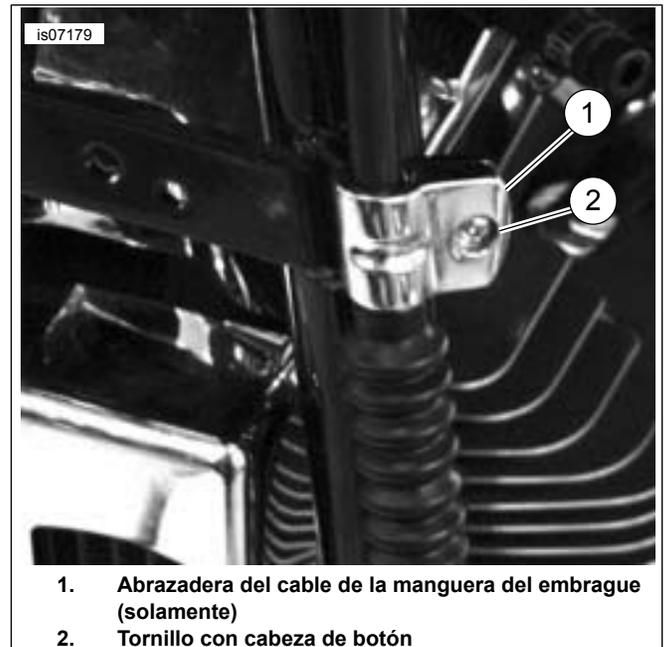
Figura 1. Instalación de la presilla del cable del embrague
