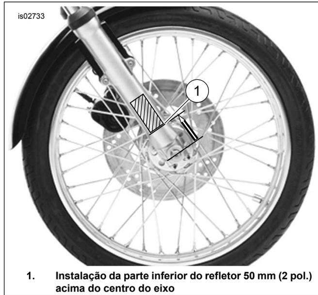
1. Instalação da parte inferior do refletor 50 mm (2 pol.) acima do centro do eixo
