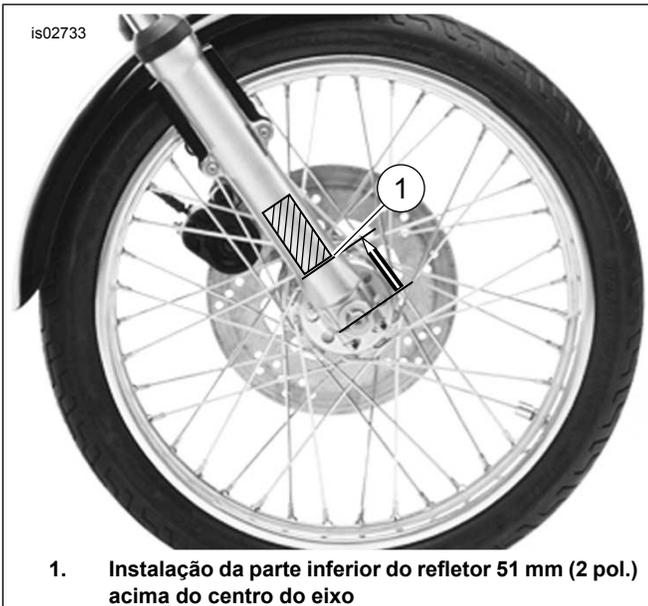
1. Instalação da parte inferior do refletor 51 mm (2 pol.) acima do centro do eixo
