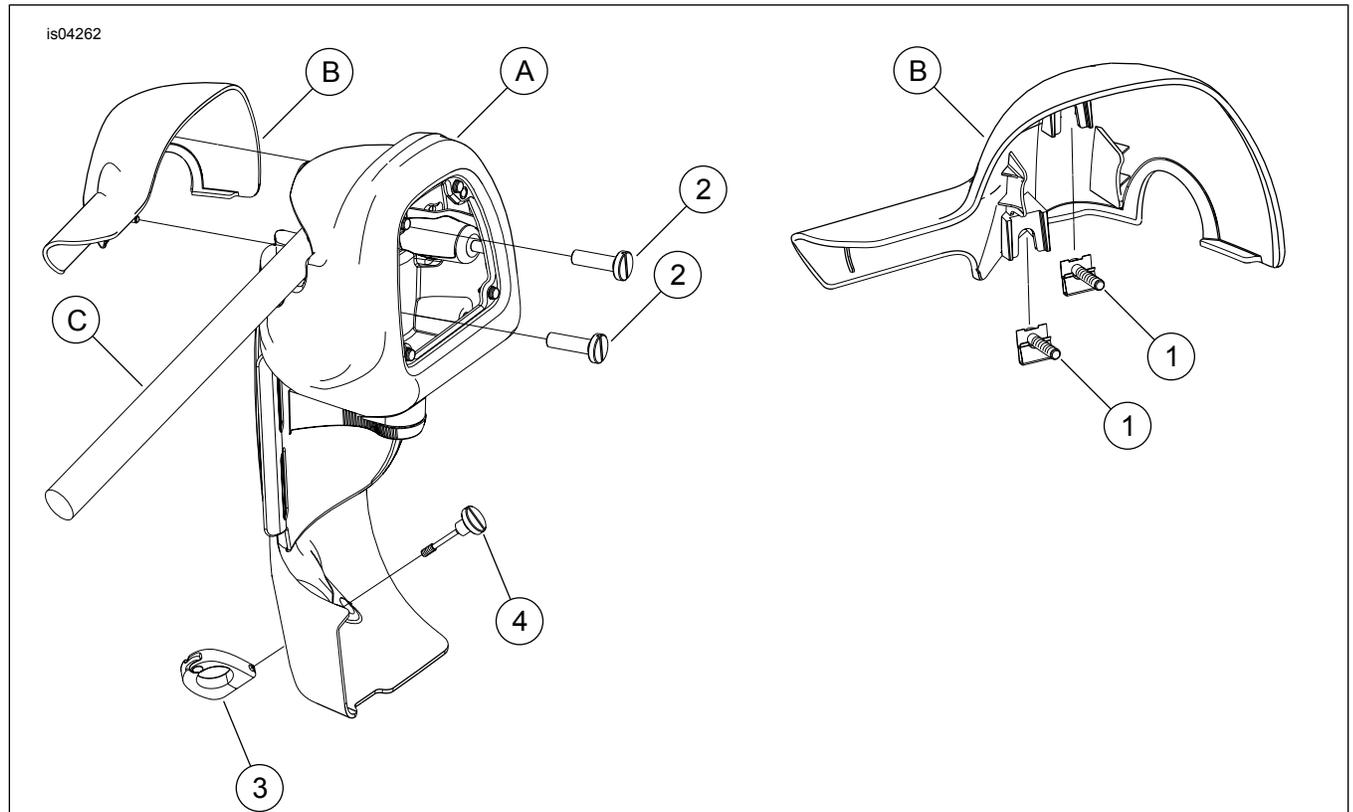
Abbildung 3. Ersatzteile: Befestigungsteilesatz für abnehmbare untere Verkleidung
