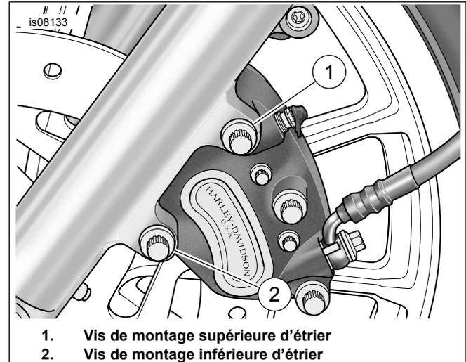
Figure 1. Retirer les vis de montage d'étrier
