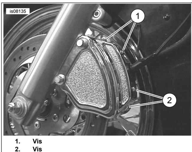
Figure 3. Installer les vis de couvercle d'étrier.
