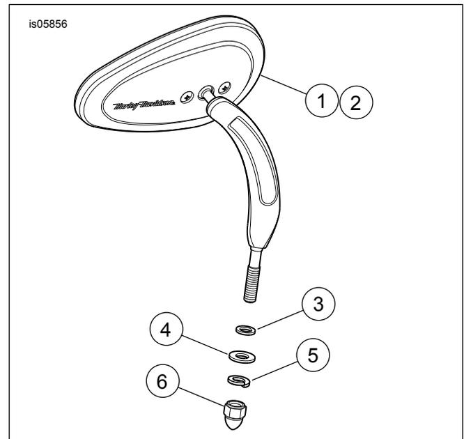
Figure 1. Pièces détachées : Kits de rétroviseur (rétroviseur style ogive illustré)
