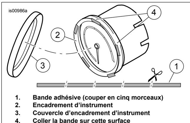
Figure 1. Installation d'encadrement d'instrument chromé
