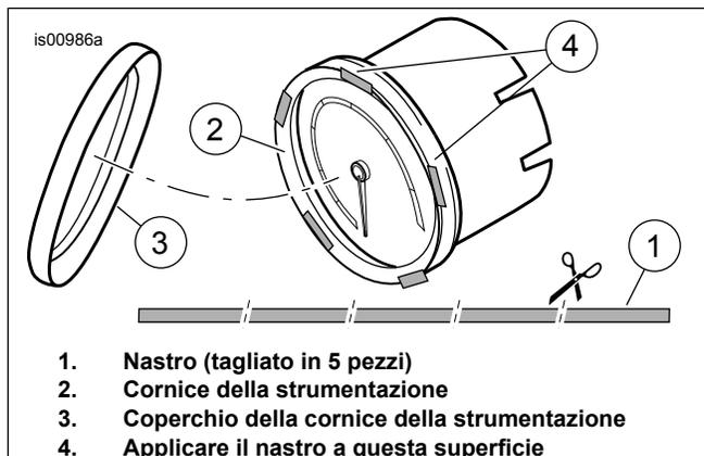
Figura 1. Installazione della cornice cromata della strumentazione
