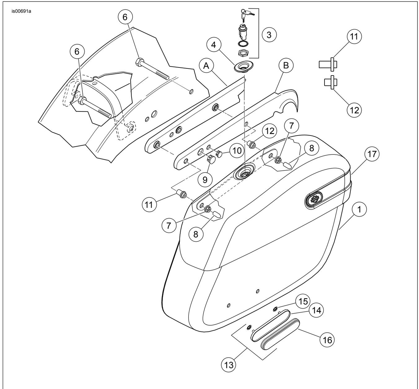
Figure 2. Pièces détachées : Kit de sacoche en cuir rigide Sportster (côté droit illustré)
