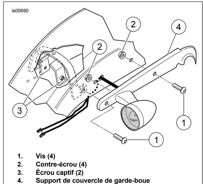
Figure 1. Dépose de support de garde-boue arrière
