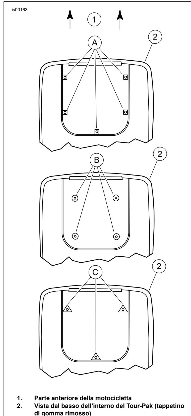
Figura 1. Configurazioni dei fori per l'attacco del Tour-Pak
