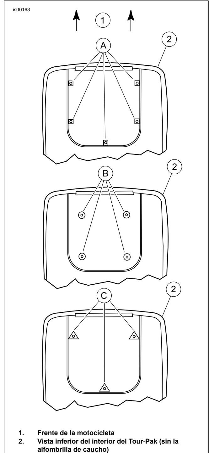
Figura 1. Configuración de los agujeros para la colocación del Tour-Pak
