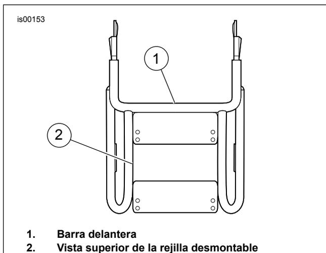
**Figura 2. Rejilla desmontable para equipaje (típica)**
