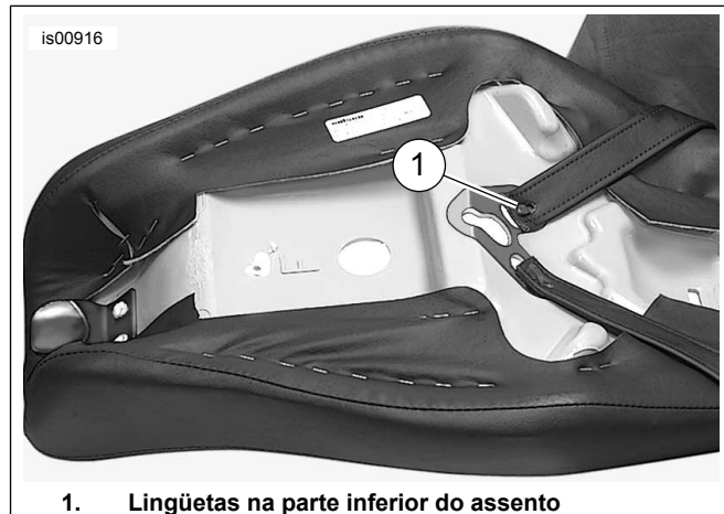
Figura 4. Parte inferior do assento mostrando a tira de apoio instalada
