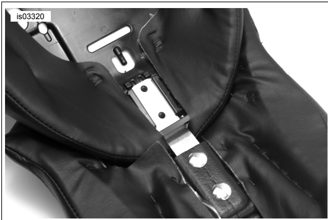
Figura 3. Parte inferior do assento e conjunto do assento traseiro
