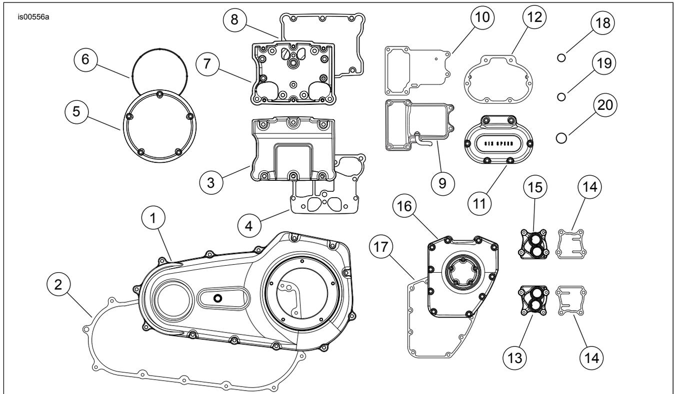
Figure 1. Pièces détachées, kit de couvercle de moteur chromé Dyna
