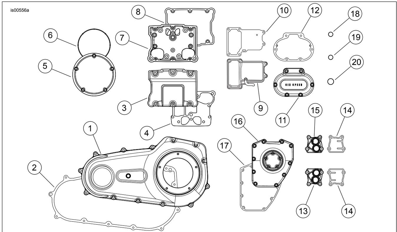
Figura 1. Piezas de servicio: Kit de cubierta cromada Dyna para el motor
