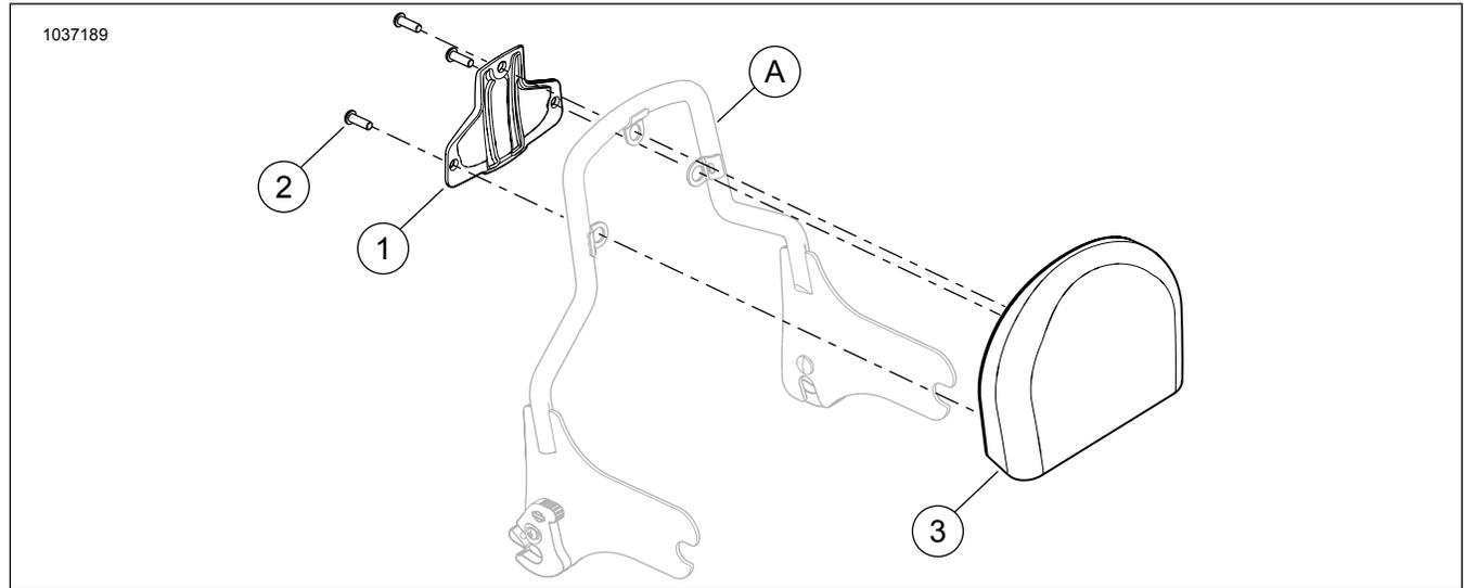
Abbildung 1. Ersatzteile: Rückenlehnenpolster-Satz
