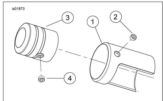
Figure 2. Pièces de rechange : Couvercles d'arbre de sélection
