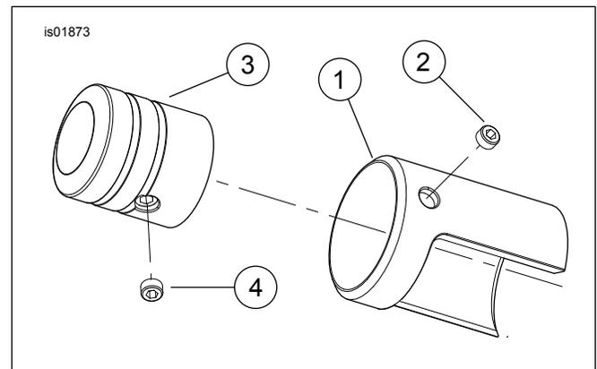
Abbildung 2. Ersatzteile: Schaltwellenabdeckungen
