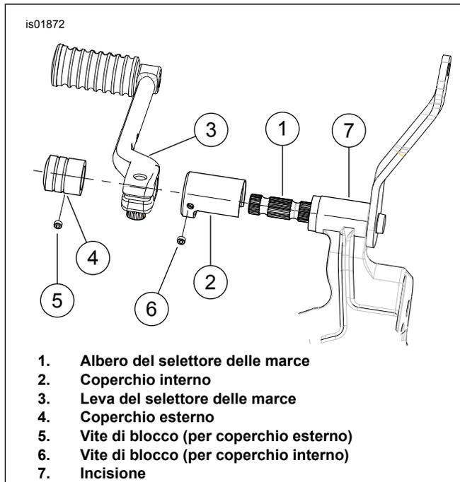
Figura 1. Coperchi dell'albero del selettore delle marce
