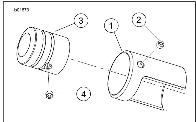
Figura 2. Parti di ricambio: Coperchi dell'albero del selettore delle marce
