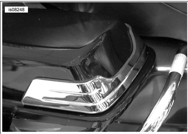
Abbildung 8. Kantenaufsatz in Einbaulage (rechte Seite dargestellt)
