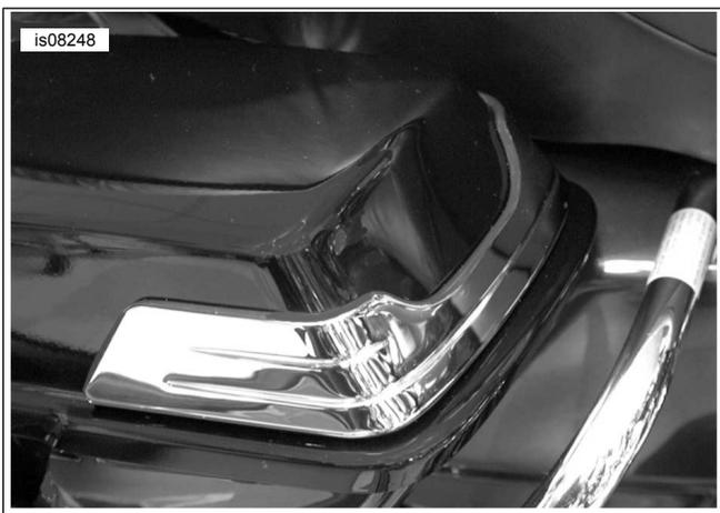
**Figura 8. Ponta da asa na posição adequada (lado direito exibido)**
