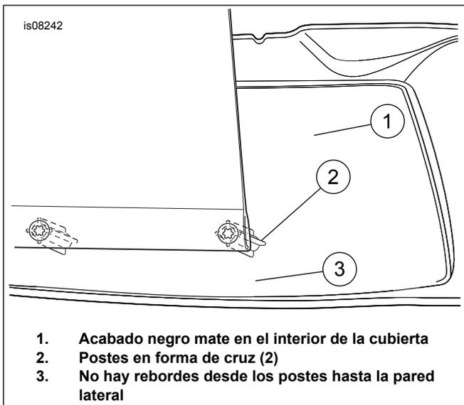
Figura 2. Identificación del material de plástico negro de las alforjas (se muestran las cubiertas laterales derechas)
