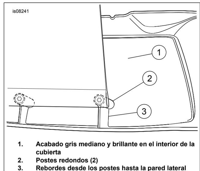
Figura 1. Identificación del material de fibra de vidrio de las alforjas (se muestran las cubiertas laterales derechas)
