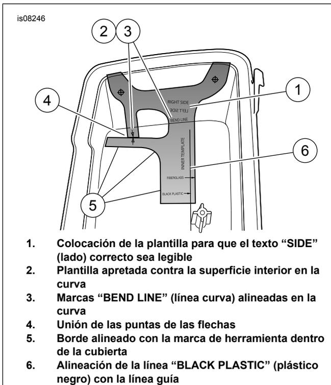
**Figura 6. Colocación de la plantilla interior (se muestra la cubierta de plástico negro del lado derecho)**
