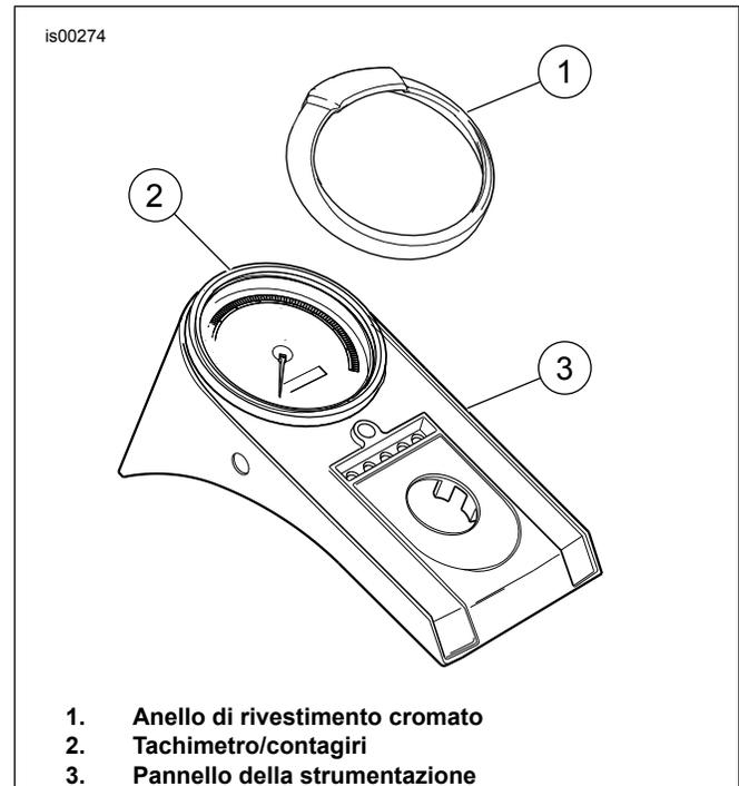
**Figura 1. Installazione dell'anello di rivestimento cromato (è illustrato il modello Softail)**
