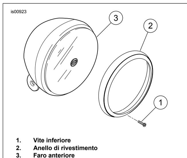
Figura 1. Anello di rivestimento originale del faro anteriore
