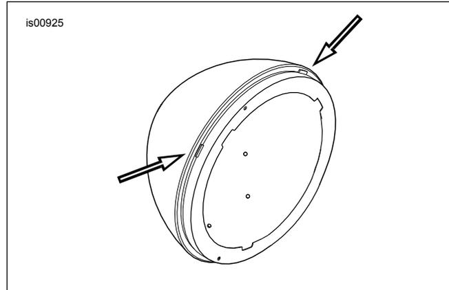
Figura 2. Controllo dei tamponi di gomma sul lato interno del guscio del faro anteriore
