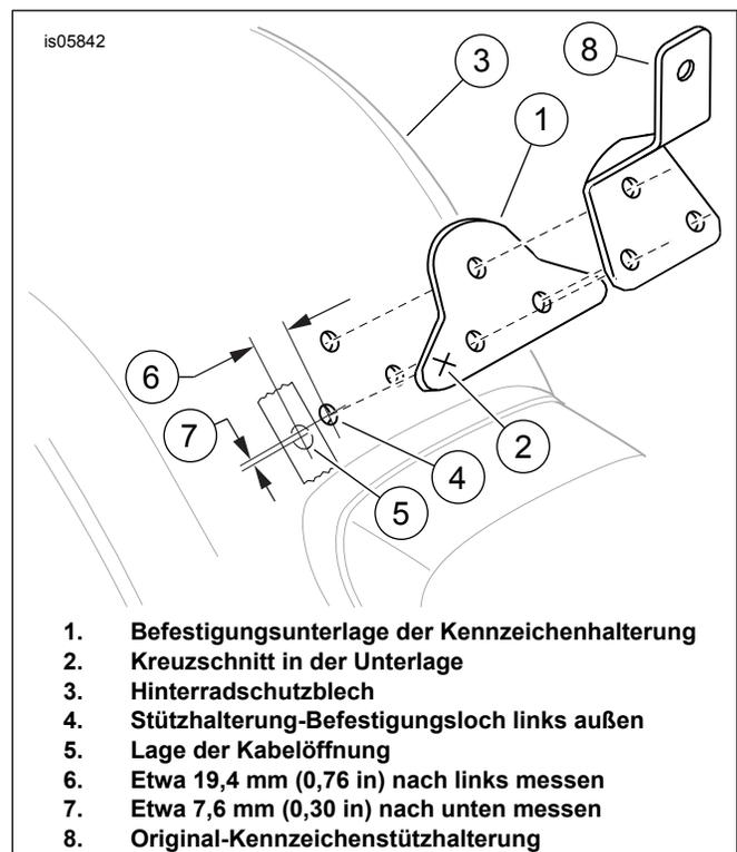
**Abbildung 6. Kennzeichenhalterung und -unterlage**
