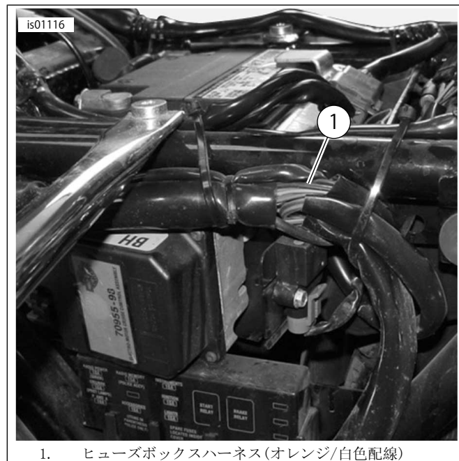
図8. 左ハンドサイドカバー後方のヒューズボックスハーネス、2003年以前のTouringモデル(図はFLHTCU1)
