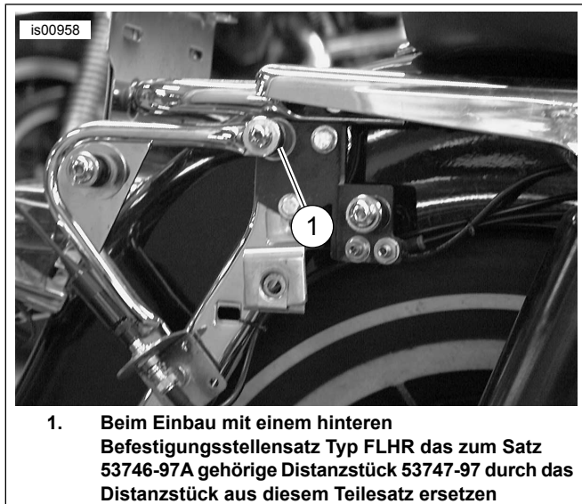
Abbildung 5. Position des Distanzstücks an der Befestigungsstelle
