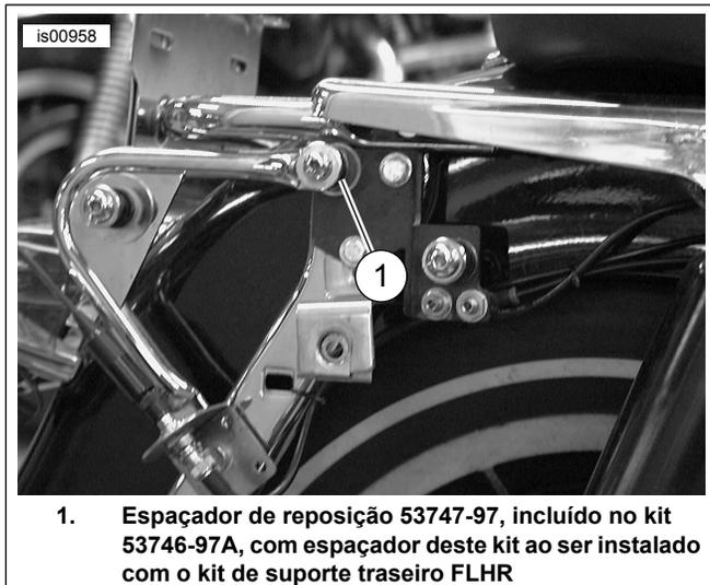
**Figura 5. Localização do espaçador do ponto de suporte**
